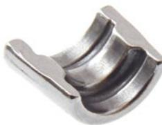
**[d]** Mit FUHR-Walzanlagen werden Profildrähte gewalzt, die zu Ventilkegelstücken weiterverarbeitet werden. Diese Kegelstücke arretieren den Federteller am Ventilschaft.
