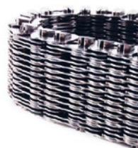
**[d]** Mit FUHR-Walzanlagen werden sowohl die Bolzen als auch die Laschen von CVT-Ketten gewalzt. Hierbei wird besonders hoher Wert auf Präzision gelegt, weil sich schon geringste Fehler durch die große Anzahl der Kettenglieder stark auf die Einbaulänge der Kette auswirken.
