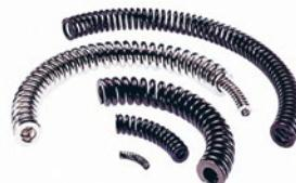
**[d]** Mit FUHR-Walzanlagen werden Runddrähte vor dem Einlauf in die Federwindemaschine an zwei Seiten leicht angeflacht, um die Blocklänge der Federn zu reduzieren ohne die Federrate wesentlich zu verringern.
