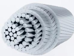
[d] Mit FUHR-Walzanlagen werden Seilverchlussprofildrähte (die drei Außenlagen im Foto) aus hochkohlenstoffhaltigen Stahlrunddrähten im Kaltwalzverfahren hergestellt. Die Vorteile des Walzverfahrens im Vergleich zum ebenfalls noch anzutreffenden Profilieren im Ziehstein liegen in der Einstellbarkeit des Kalibers und der geringeren Gesamtumformung, die den Werkstoff weniger stark belastet.
